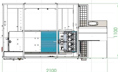
La cinta de salida a través de la que el producto es expulsado fuera de la sierra una vez cortado hacen de esta una sierra ampliamente versátil, siendo capaz de cortar con exactitud cualquier producto congelado o fresco, ya sea carne, pescado o verdura. En función del tamaño del producto pueden cortarse una o varias piezas al mismo tiempo.
