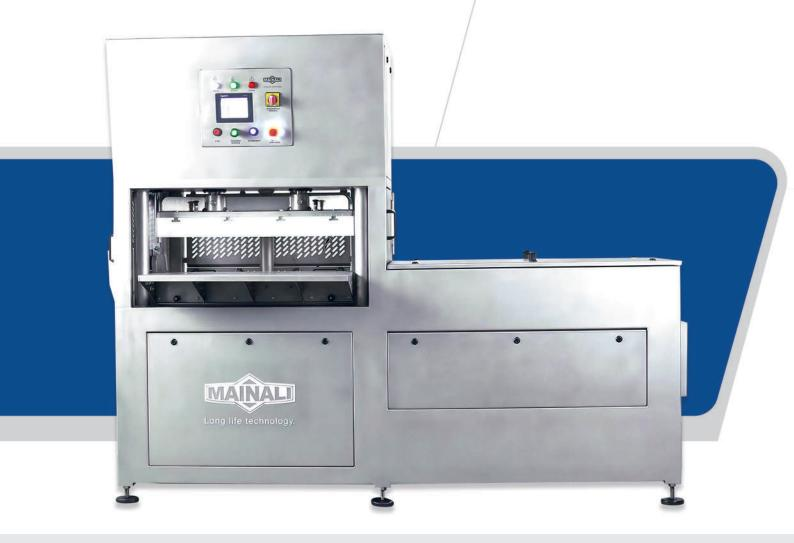
La PRENSA 3D compuesta por 3 grupos de pistones ha sido diseñada para prensar alimentos curados o congelados deshuesados, temperatura entre -12°C y 0°C.
